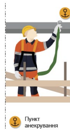
Мал. 2. Пункти анкерування індивідуальних засобів, що охороняють перед падіння із висоти
